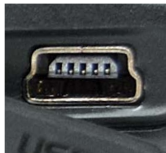
Um die gespeicherten Datensätze mit den Fotos zu koppeln, wird der Logger via USB-Schnittstelle an den PC oder das Laptop angeschlossen.
